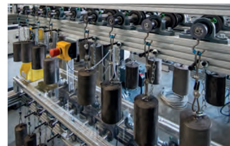
易格斯在行业最大、用于工程塑料运动的实验室中增加了 xiros® 测试装置
