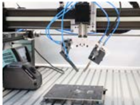
得益于集成的igus机器人控制系统，多轴直线机器人自动地将连接器和电容器焊接到电路板上。
