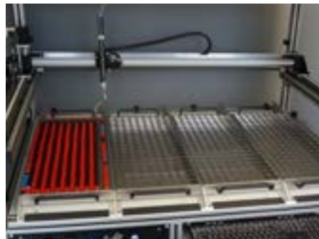
免维护且自润滑的igus直线机器人用来执行生化液体的灌装任务。
