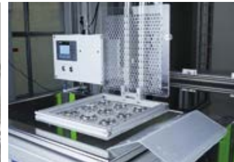
直线机器人可在水下进行自动密封性测试。
