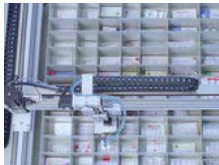
室内直线抓取机构简化了药店的药品分发工作。
