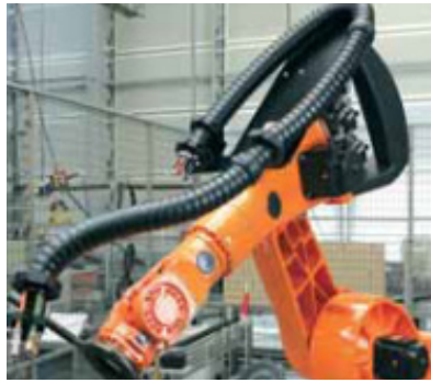
triflex®RS有预紧功能的一体化的碳纤维棒，防止管线在机器人过度缠绕。
