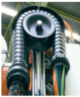
triflex®RSP气动伸缩系统-避免机器人管线包缠。
