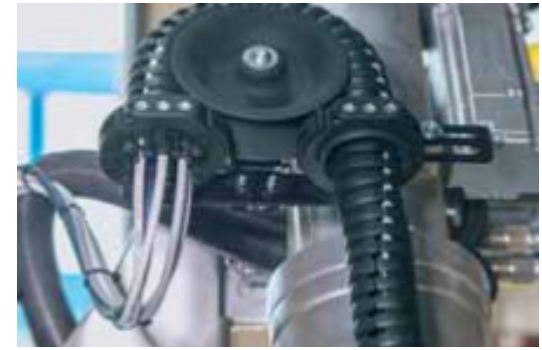
triflex®RSP气动伸缩系统-避免机器人电缆缠绕。
