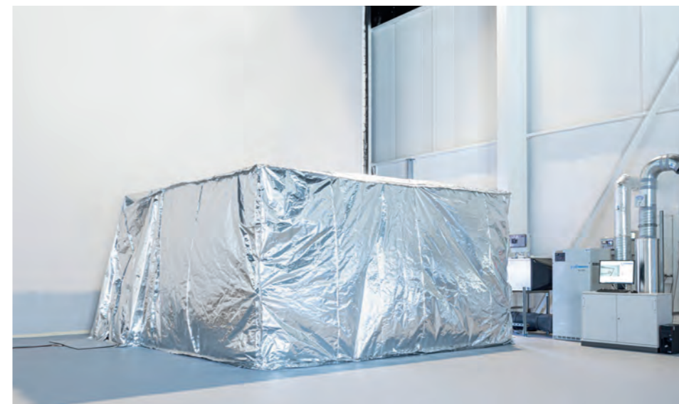
用于干燥室测试的DryClean-CAPE®；资料来源：弗劳恩霍夫IPA研究所
