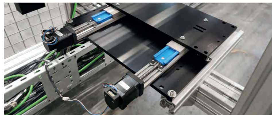
在耐久性测试中：两套 NTM-45 系统采用水平安装方式，系统长度 200 mm，运行速度 0.015 m/s
