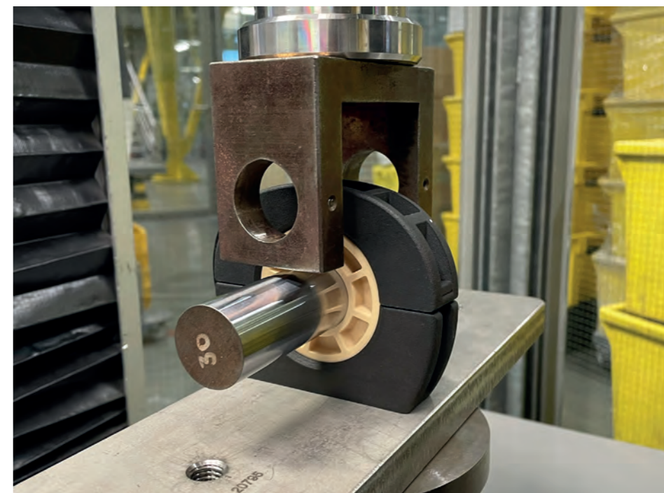
对我们的快拆式基座轴承（带3D打印外壳）进行压缩测试后，我们确定其静态抗压承载力可达 13.5 kN。
