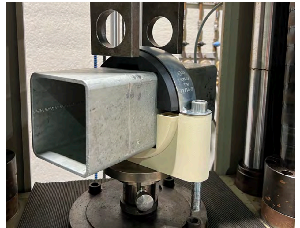
3D 打印的 ESQM-2.0-120-HD 原型接受测试。
