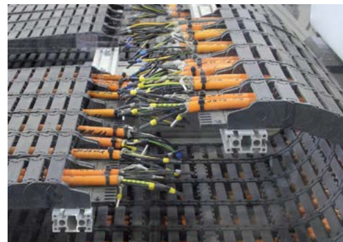
在高负载情况下，对使用在 igus®e-chain®拖链中的igus® chainflex® 高柔性电缆进行测试
