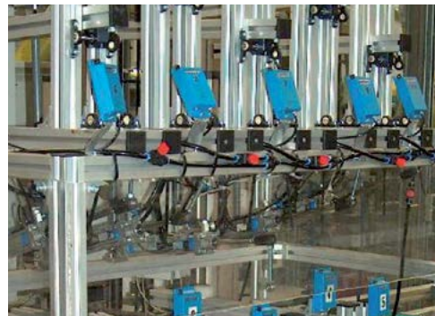
在中等载荷下，摆动运动的磨损测试
