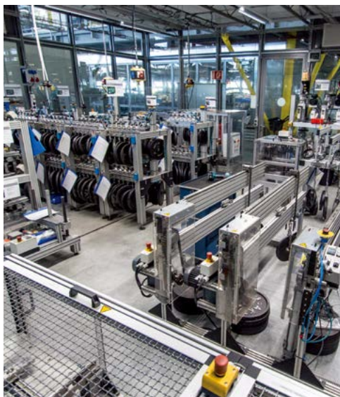
在易格斯测试实验室进行滑动轴承的耐磨测试
