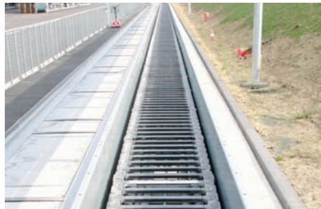
P4.56 拖链: 长达 120 m 的户外应用 P4.56: igus® outdoor test set up - travel length 120 m
