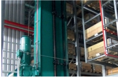
易格斯 guidelok slimline F 用于安全垂直导向 (28 m 行程) With cost-effective igus® guidelok slimline “F” safe vertical guiding (here: 28 m)
