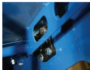
高性价比的 igubal® 法兰轴承用于旋转铲 Cost-effective igubal® flange bearings in a rotary sorter
