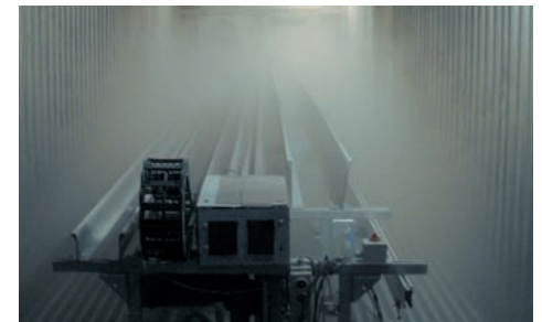
低温测试: 拖链和电缆在 -40°C 下运行 Frost test of cables and e-chains® at -40°C
