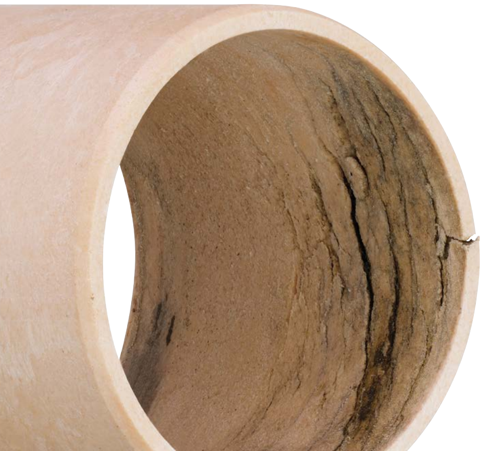
图为过载对轴承造成的损坏 ...
