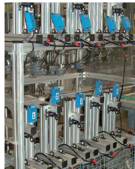
图 11: 用来测量中等载荷的摆动运动时的磨损量的摆动磨损测试装置
