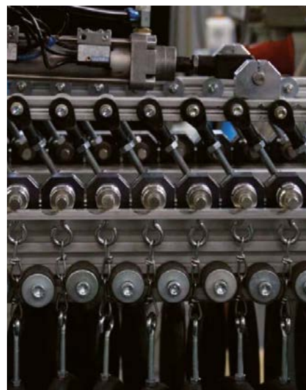
图 10: 用来测量低载摆动运动时的磨损量的摆动磨损测试装置
