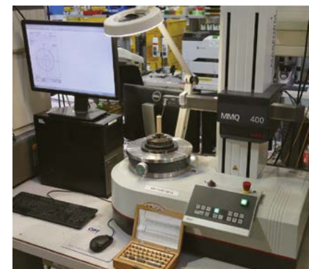
图 13: 压配合滑动轴承内径的测量
