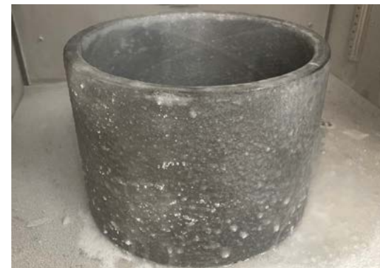
冷冻处理后的igutex® 滑动轴承
