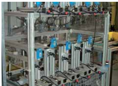
中等负载下的耐磨实验
