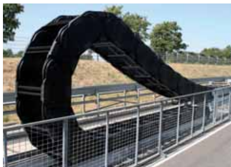
240米长行程拖链24小时不间断测试
