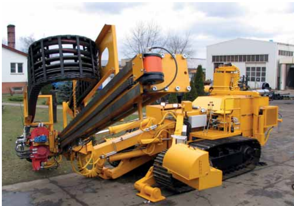
装有高压油管的 igus® H4 拖链应用于锚杆钻
