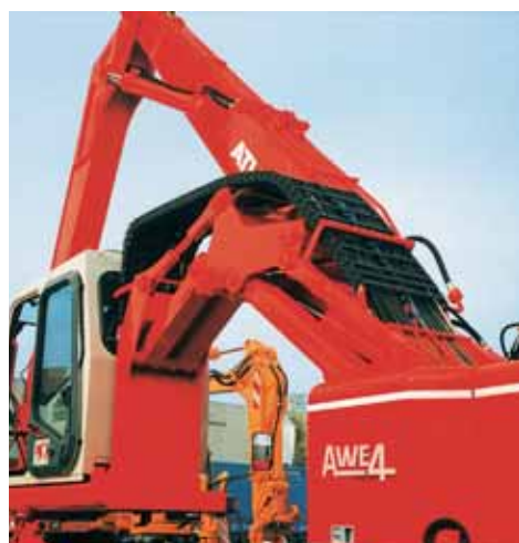
E4 拖链应用于挖掘机驾驶室
