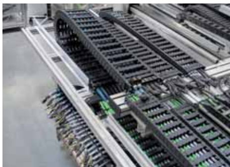
电缆使用寿命测试，6500万次双循环
