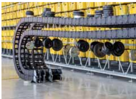
嵌套拖链架空极限实验
