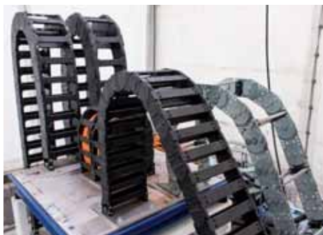
塑料拖链和拖链高强度震动的对比实验
