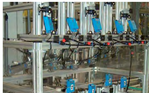
可开展旋转磨损试验，测定 iglidur® 材料的磨损特性
