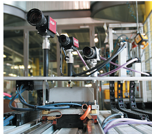
10米CFBUS.066 (USB 2.0) 安装在拖链 B10.015.100内，与USB 2.0摄像头连接，可实现350万次的往返运动。
