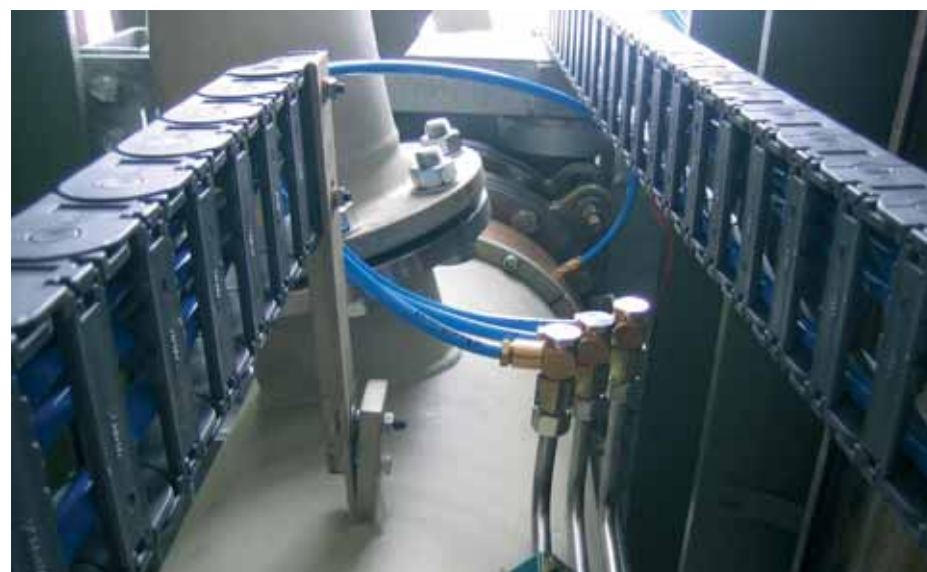
igus E2/000系列ESD拖链在油罐加注站的应用。
