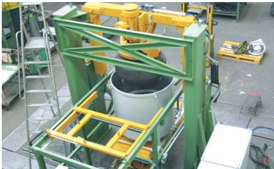
离心机中使用igus E2/000系列ESD拖链。链用于，以实现除油、干燥、冲洗、涂层和防锈功能。
