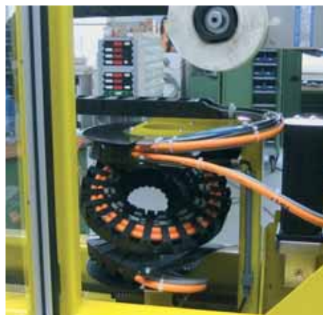
igus® twisterband TB30适用于圆周运动, 旋转角度可达360°, E2 mini和E2/000系列的拖链可用在下载和上传模块
