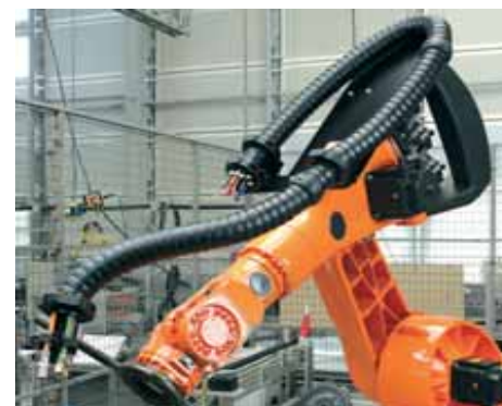
triflex® RS 适用于紧凑型导轨。有预紧功能的一体化的碳纤维棒, 防止管线在机器人上过度缠绕
