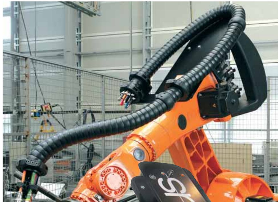
triflex® RS适用于紧凑型导轨。triflex® RS 伸缩模块与机械臂平行。在线视频▶ www.igus.com.cn/RS_Film
