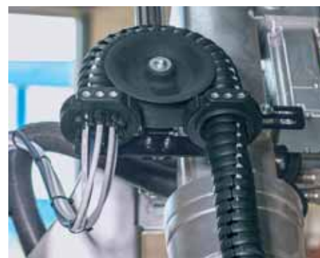
triflex® TR.RSE.40.L 或 R, 高性价比且自重轻, 带导向滚珠的伸缩系统, 适用于小型机器人
