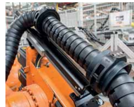
适用于 triflex® R, 尺寸 40-125 的 TR.RSE 线性伸缩系统
