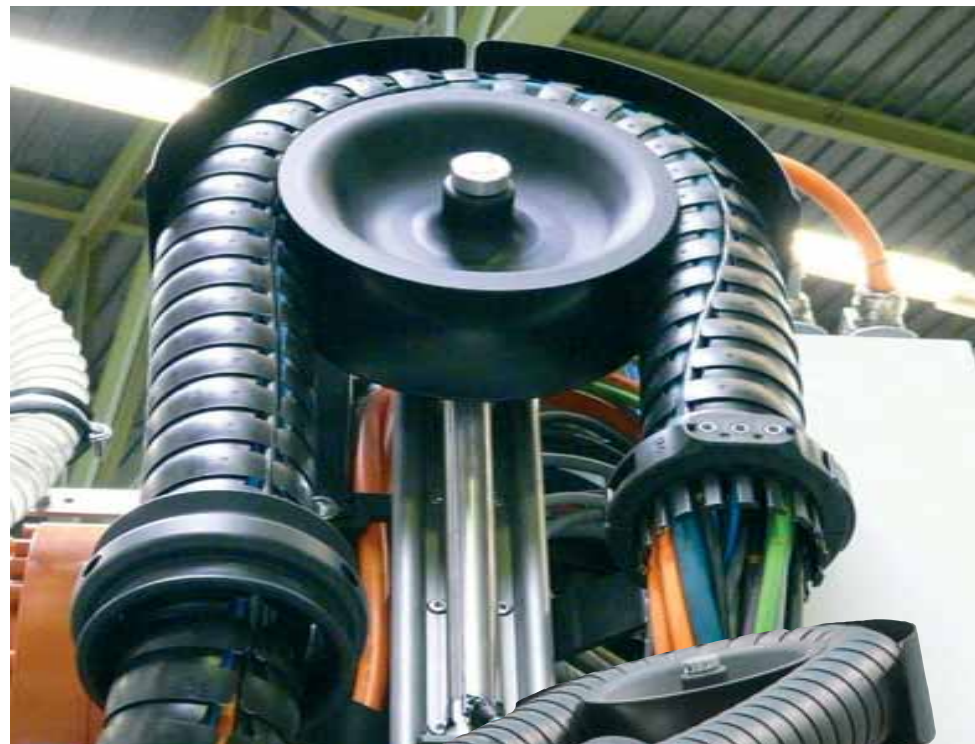
triflex® RSP 气动伸缩系统- 避免机器人管线缠绕
