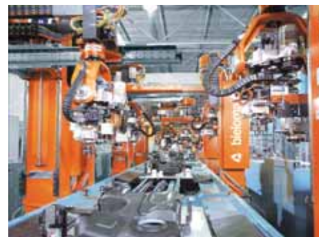
igus® 方便型triflex® 和E2 中型拖链用在生产线上。
