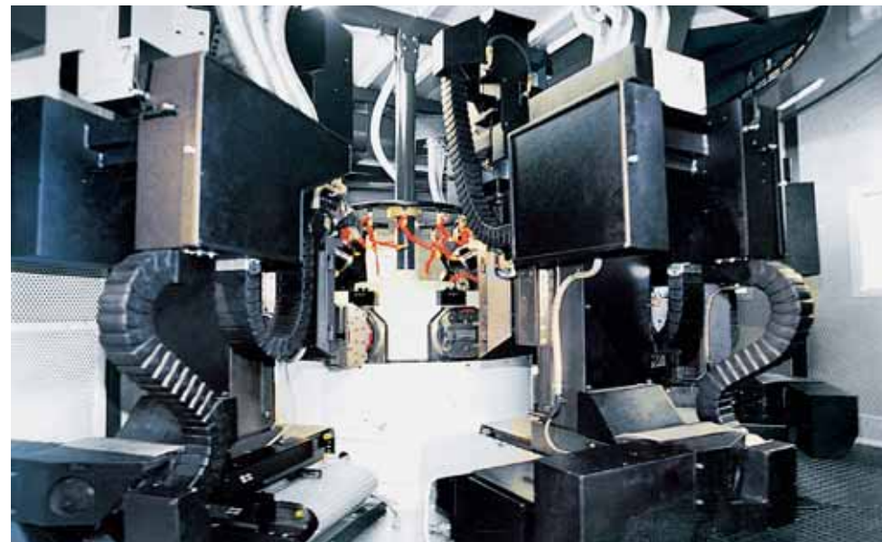
在加工中心的内部使用了多种triflex® 拖链
