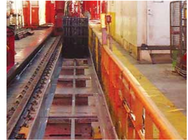
E4拖链系统, 带拓展链节 - West Navigator号上的长行程应用
