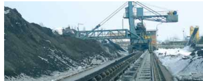
煤炭装卸的极脏污恶劣的环境, 易格斯滚轮拖链在钢制导向槽中运行。
