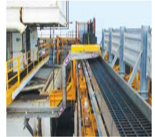
带多个拓展链节的E4拖链, 可承受极高负载, 由钢制导向槽引导, 用于极恶劣环境的长行程应用。
