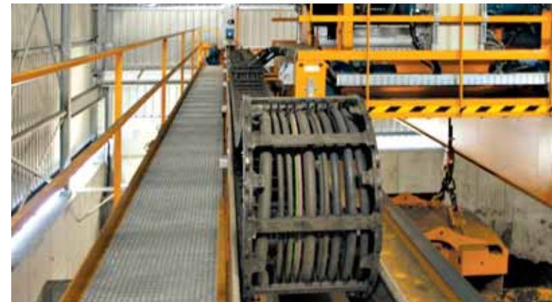
安全引导。起重 机行程32m, 速 度80m/min。
