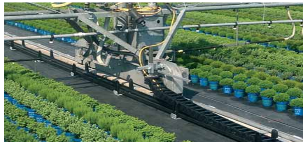
E2/000轮式拖链, 带guidelite导向槽, 可用于作物灌溉
