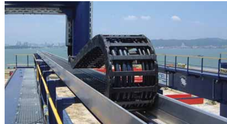
E4系列拖链及导向槽可耐海水腐蚀
