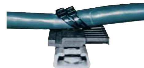
使用易格斯梳状板和电缆扎带的抗拉强度测试
