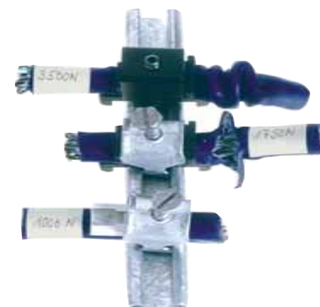
易格斯测试: 比较三种不同的去应力元件 - 与传统电缆夹相比, chainfix 产品具有三倍以上抗拉强度。
