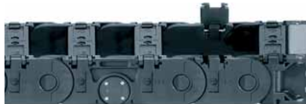
E2/000 轮式拖链 - 每个链节均有横杆 横杆可沿外半径方向从两侧打开
