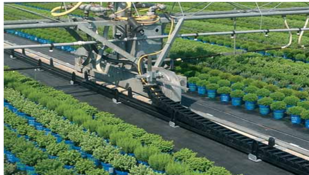
灌溉设备, E2/000轮式拖链运行于guidelite导向槽中。
