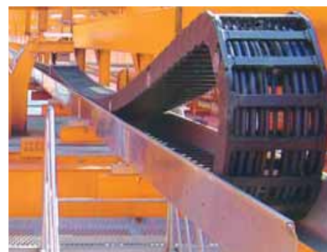
易格斯E4/4轮式拖链在长行程运行中需要所需驱动力更少。由易格斯导向槽安全引导。
