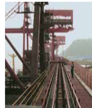
在卸煤系统中使用轮式拖链，符合防火等级要求 - 行程190m, 负载 8 kg/m, 速度0.5 m/s
