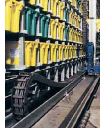
配有E2系列和chainflex®高柔性电缆的自动仓储系统 - 行程可达80m，速度可达4.5m/s
