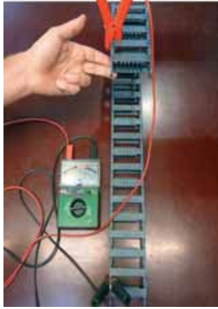
ESD系列拖链“从一端到另一端”被检测持续的100%导点率
