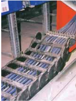
接头降低安装高度实例
