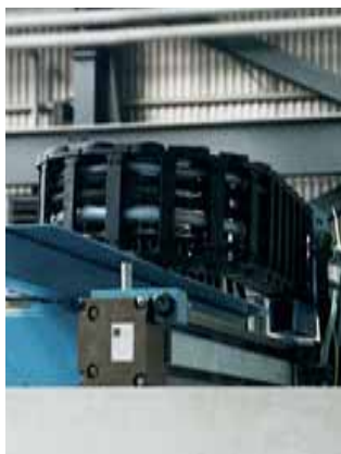
横向的拖链，拖链的单侧需有支撑
