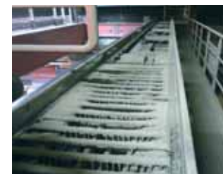
E4系列拖链在焚烧厂中的应用--在污垢和灰尘的环境中也能安全运行
