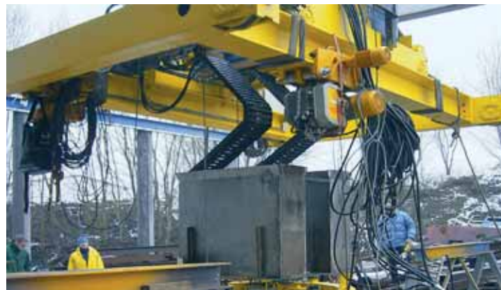
Zig-zag 应用：废弃的核电站。用于约14m高的钢制容器内的磨碎处理
