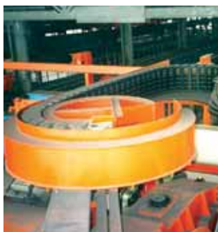
起重机回转台上标准拖链实现180°旋转运动
