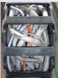
电缆和介质管在拖链系统中不会起旋
