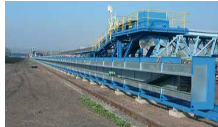
使用易格斯轮式拖链和易格斯高柔性电缆的长行程应用，行程615m
