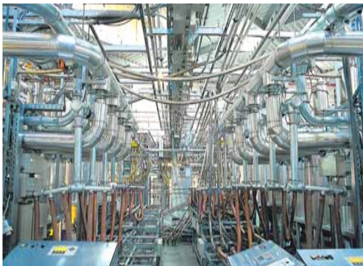
易格斯工厂-处理igumid G / GLW材料的自动组合及输送设备
