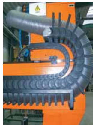
采用E4拓展杠杆引导吸管, 并与E2拖链嵌套使用
