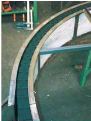
易格斯RM系统 - RBR 的导槽可适用于旋转运动
