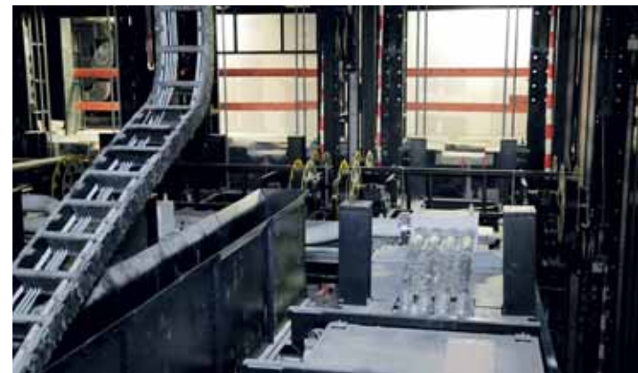
应用于剧院的易格斯e-spool 和zig-zag 方案。节省空间，免维护：在任何方向都可安全地引导各种能量、数据和介质。
