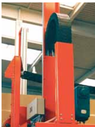
带U型档板的拖管系统，用于较高的横向加速度
