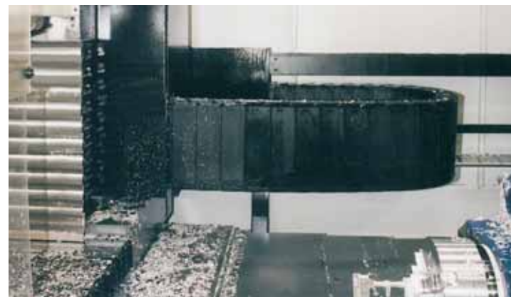
E4系列轻型拖管可用于切削加工区
