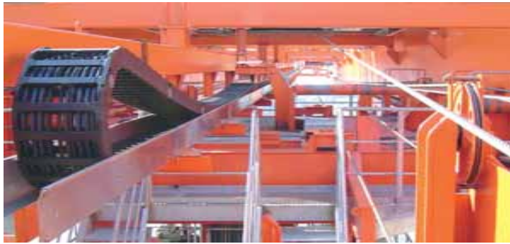
长行程的轮式拖链 - 更节能
