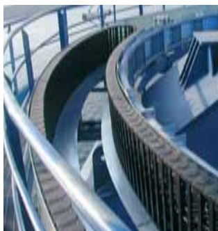
igus® E4系列拖链在起重机上做RBR-旋转运动
