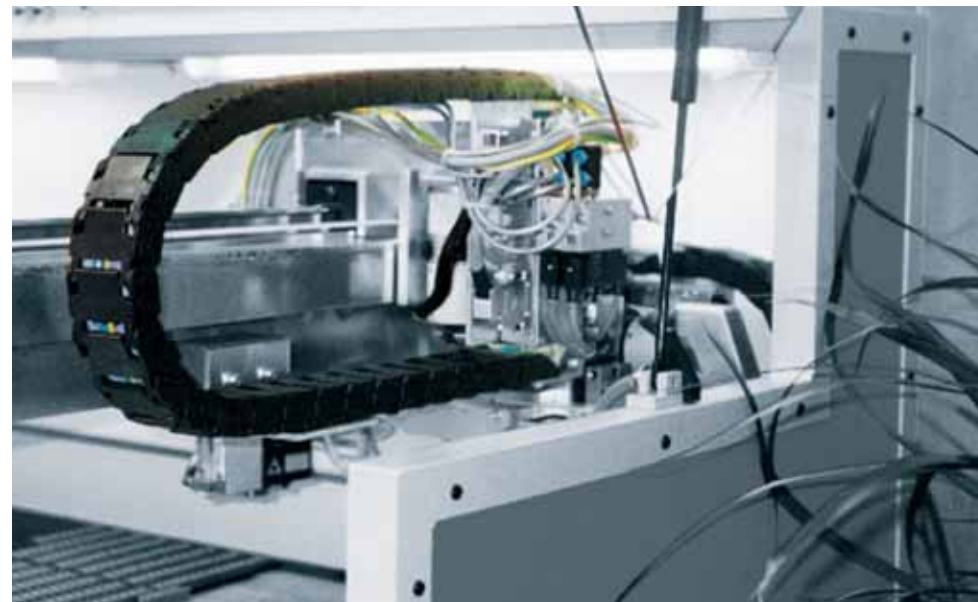
易格斯拉链式15系列拖链应用于特殊设备，快速安装管线。
