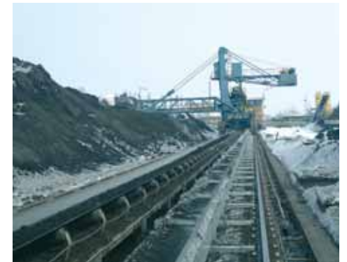
180m行程应用中采用4040HD系列拖链, 温度范围-40°C/+40°C
