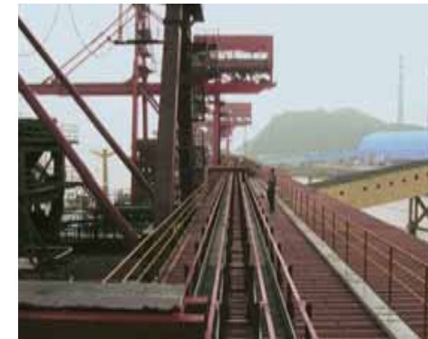
4040R系列可用于卸煤系统。行程190 m, 速度0.5 m/s, 负载8.05 kg/m
