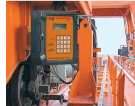
采用易格斯PPDS系统实时监测驱动力的长行程应用
