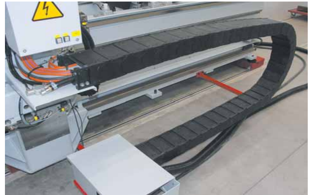
E4/轻型拖管可有效防护灰尘和切屑
