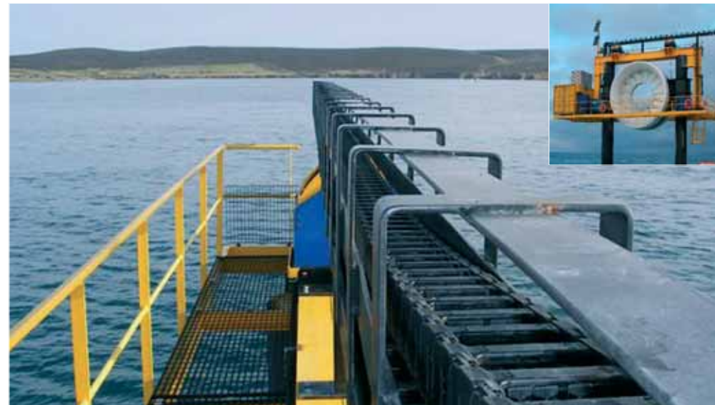
4040系列拖链保护高柔性电缆不受涡轮机上下运动的影响, 也使它们能够抵抗恶劣的环境。可实现行程达20 m的水上和 水下运动
