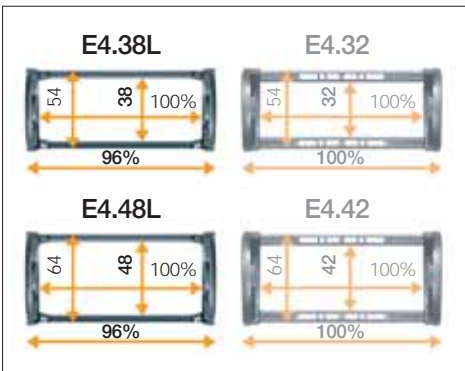
采用更薄的侧板，优化的横杆结构，实现理想的内外尺寸比
