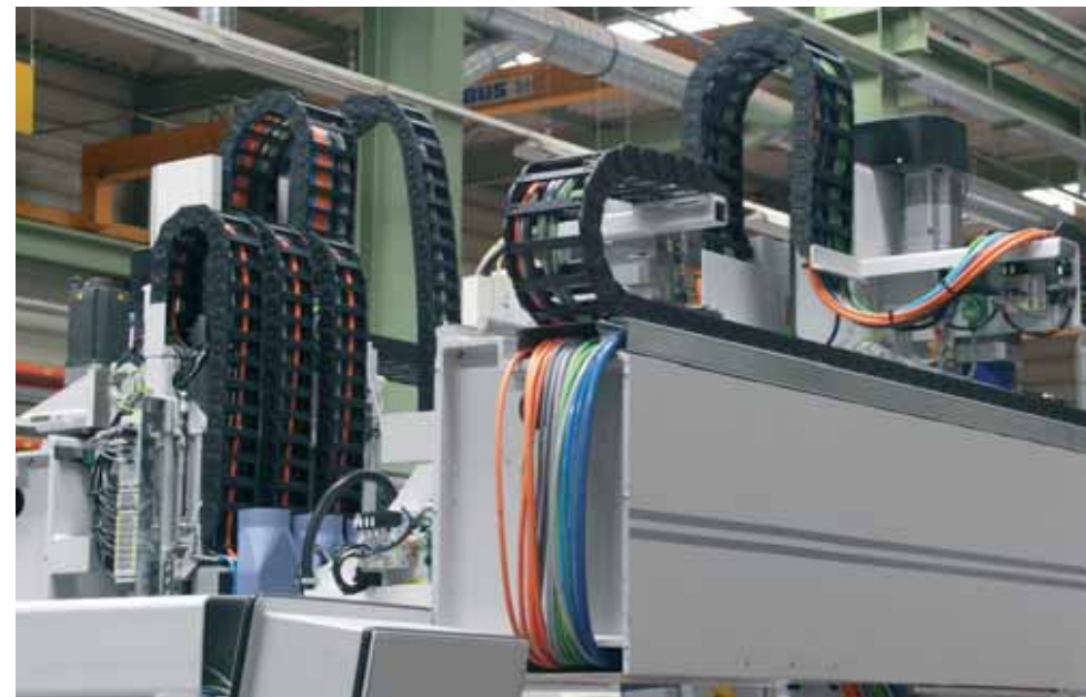
木工机械行业的CNC机床上很多都使用了易格斯拖链。
