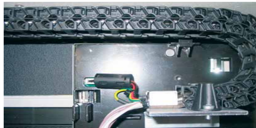
易格斯E3系列拖链, 有极低的噪音, 适用于极其小的安装空间和小的弯曲半径。
