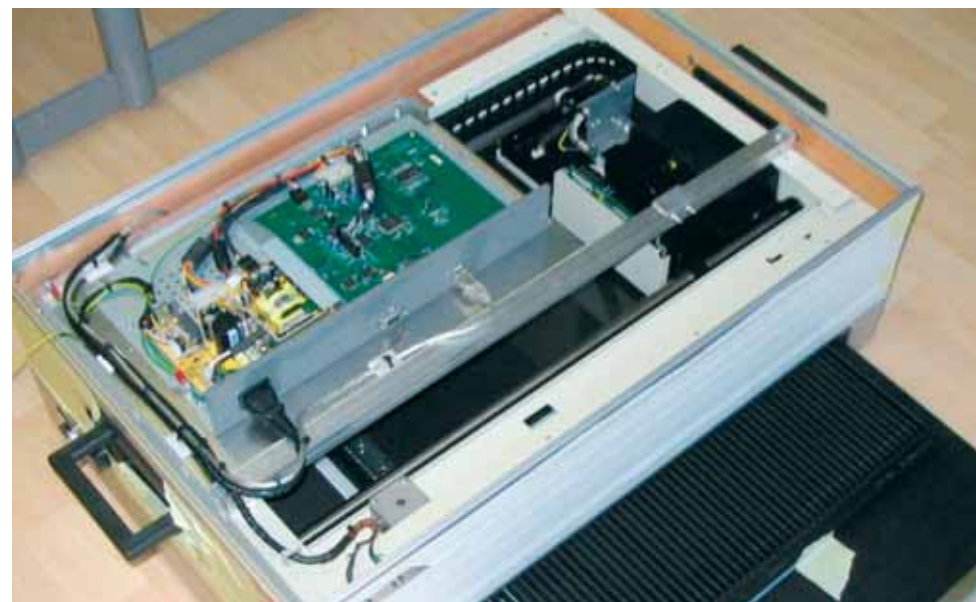
igus® E3.15系列侧倒安装于平板扫描仪, 低磨损引导电缆
