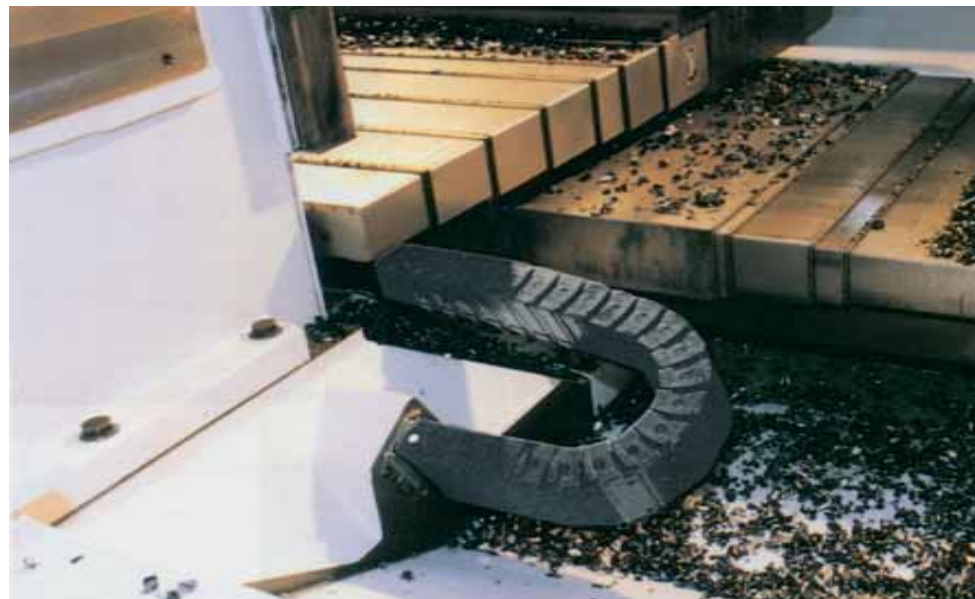
易格斯E2系列拖管可用于机床加工切屑区。可耐+850 °C 的高温碎屑
