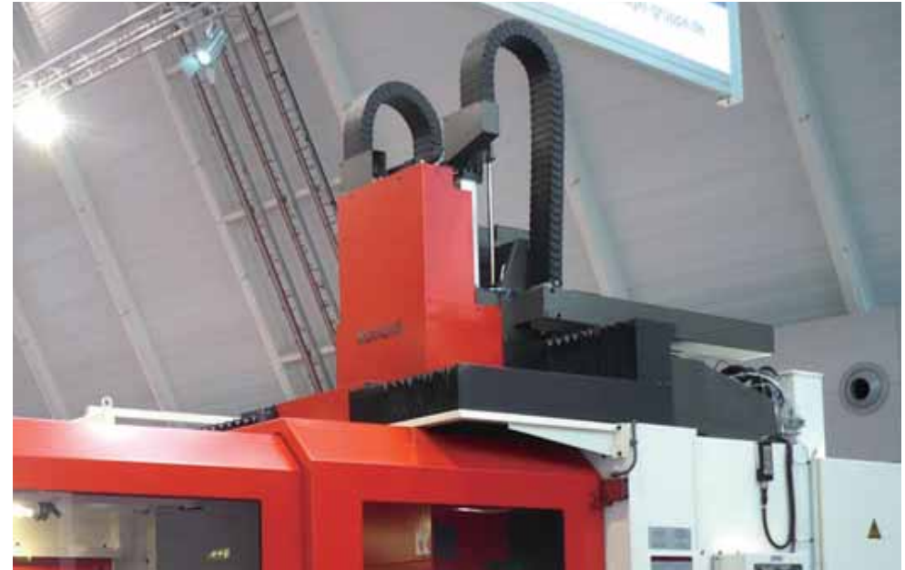
易格斯E2R100拖管典型应用-机床站立应用。
