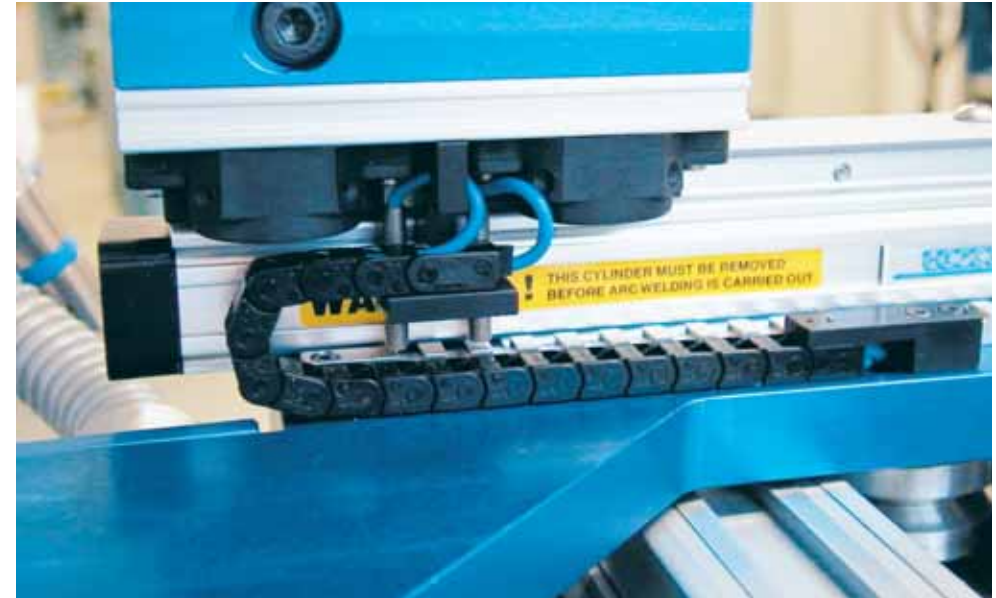
03系列拖链 - 适用于极小安装空间的最小尺寸耐污垢易格斯拖链: 喷涂设备
