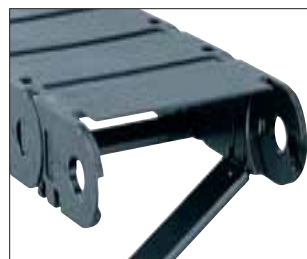
半封闭拖管- 沿外半径方向为全封闭结构。横杆沿内半径方向可从左右两侧打开
