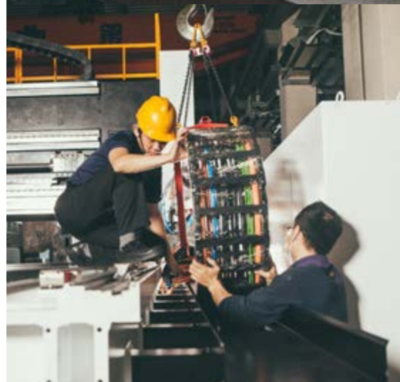
预装配的易格斯拖链作为完整的装配拖链系统（含安装支架）交付给Hartford。
