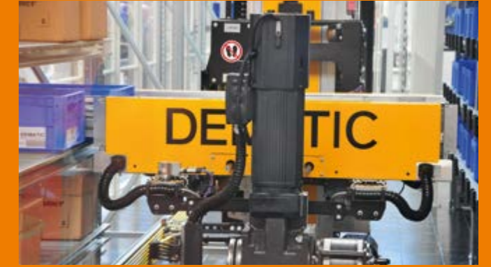
triflex® R用于仓储和提取设备中
