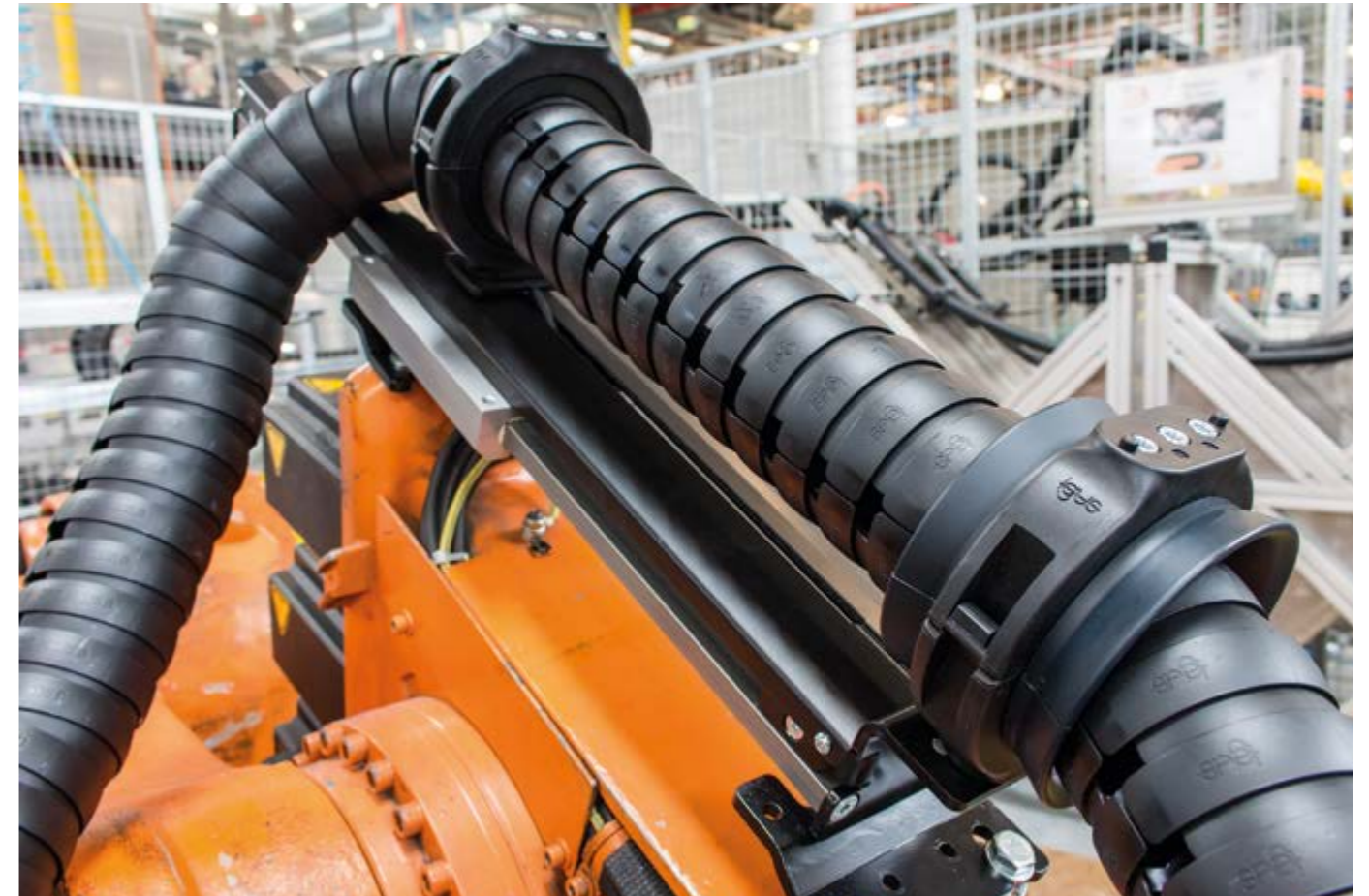
用于测试机器人的易格斯TR.RSE系统
