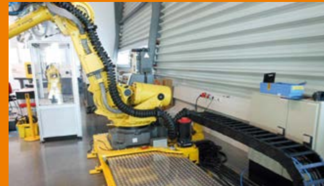
triflex® R用于机器人1-6轴, E4.1系列用于机器人第7轴
