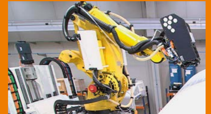
triflex R安装在机器人的机械臂上
