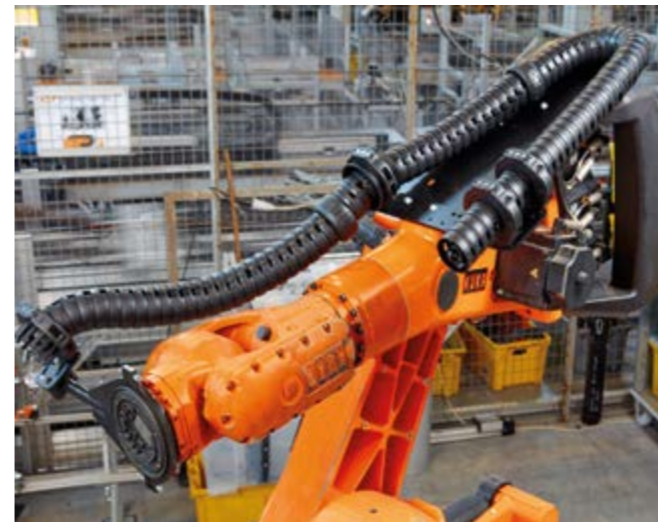
triflex® RS模块化伸缩系统 - 集成了有方向保护功能的碳纤维棒，避免机器人在工作区域的管线缠绕
