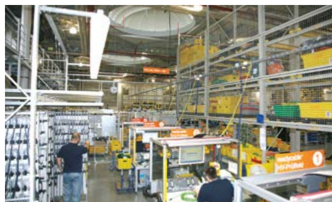
所有预装配电缆经过高压测试和线序检测
