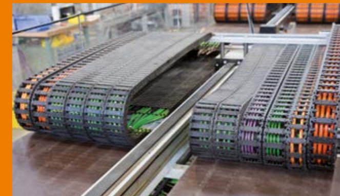
弯曲半径测试，在9.4xd的弯曲半径下完成7,600万次循环
