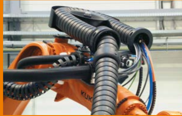
在机器人机械臂上紧密布线, 无缠结
