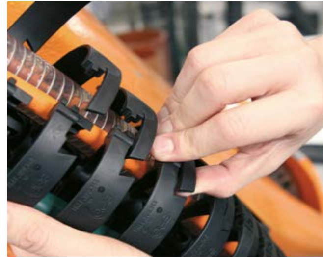
igus® triflex® R TRLF系列 - 轻型，用手或螺丝刀可轻松打开
