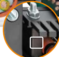
10mm的垫片可用于多种安装高度中
