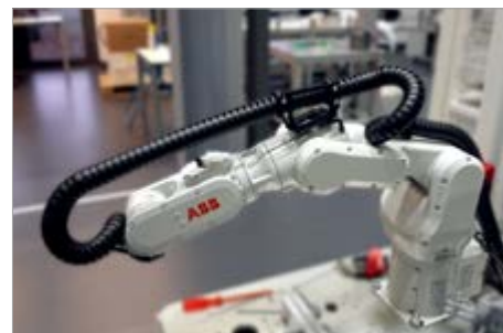
装有30直径碳纤维棒的低磨损供能系统用于ABB IRB 1100
