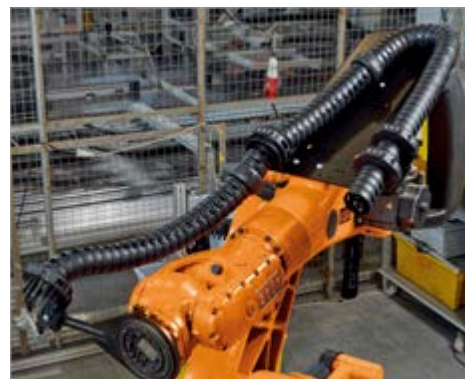
triflex® RS是一种结构紧凑的伸缩系统。它可实现多轴triflex® R拖链与机械臂一并运行。
