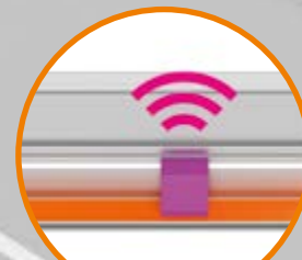
集成在导槽上的智能化系统： 可监测拖链运行的行程
