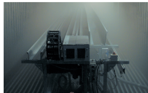
高柔性电缆和拖链在-40 °C的环境中进行的寒冷测试
