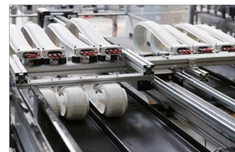
在易格斯德国科隆实验室(3,800m²)测试的使用寿命测试。
