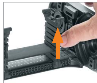
内部分隔通过拖链两侧集成的横杆固定。
