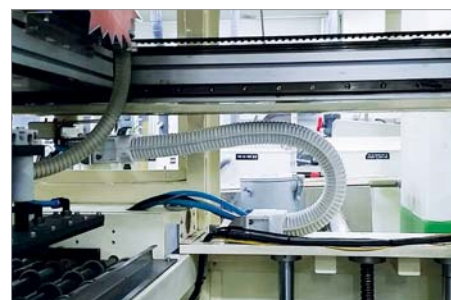
耐磨损的 e-skin® 波纹管应用在印刷电路板的绝对无尘环境。
