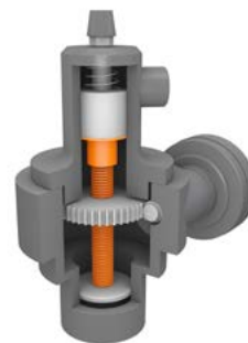
dryspin® 丝杆技术应用在汽车制动器的蓄压器中
