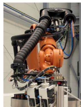
igus® chainflex® 电缆用于C轴机器人上的多维 triflex® R 拖链
