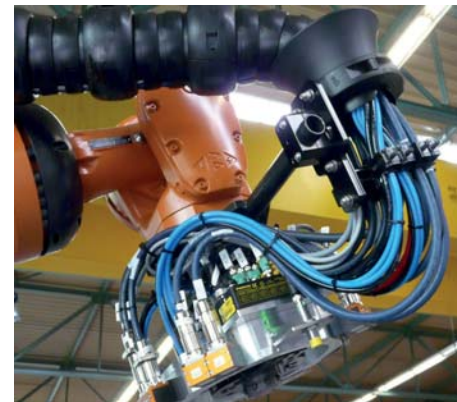
CFROBOT® 电缆用于燃料机自动化机器人生产线。 整套管线包以 readychain® 装配拖链系统形式供应。
