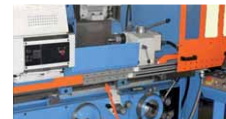
drylin® NT LM 用于机床移门的调节
