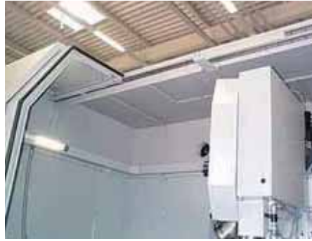
使用在硬质阳极化导向轴上的drylin® 直线滑动轴承来导向机床的安全门，即可平滑且低噪音运行，经济型。
