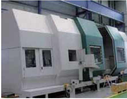
使用在硬质阳极化导向轴上的drylin® 直线滑动轴承来导向机床的安全门，即可平滑且低噪音运行，经济型。
