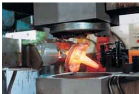
iglidur® X材料应用在铸造厂的高温环境下的重载型应用
