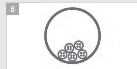
传统波纹管无法实现内部空间分隔
