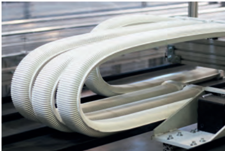
在易格斯实验室, e-skin®以v=3m/s的速度, 耐受了超过1,000万次循环测试(截至12/2020)。
