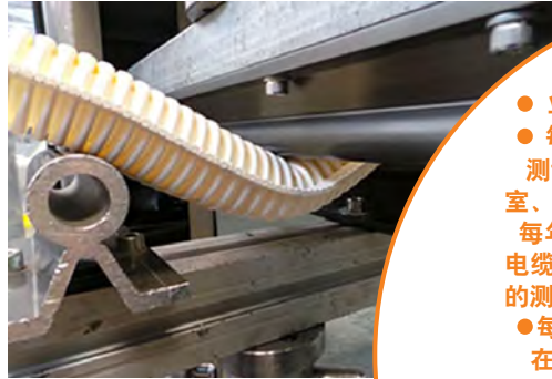
e-skin® soft无尘拖管进行弯折测试
