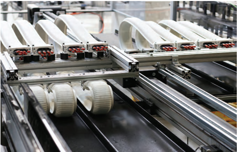
在易格斯德国科隆测试实验室(3,800m²)进行使用寿命测试。
