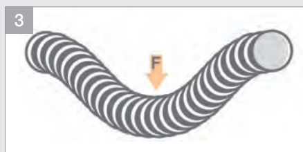
传统波纹管横向受力后, 无法保持稳定。
