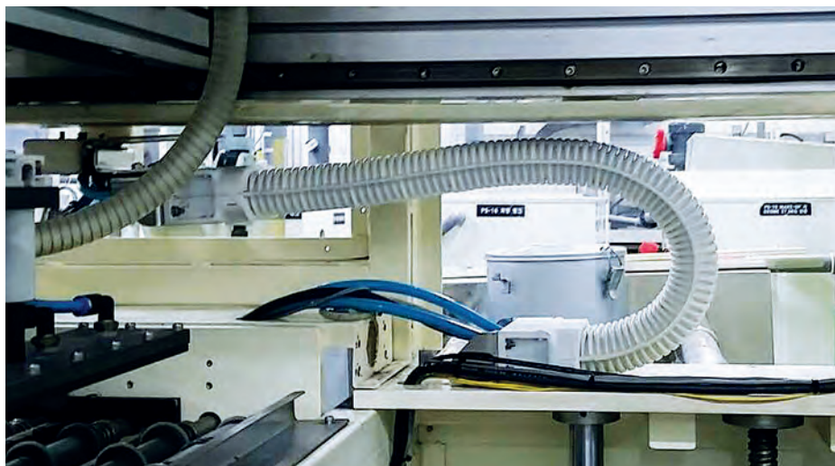
电路板生产需要绝对无尘的环境, 采用了易格斯的耐磨 e-skin®
