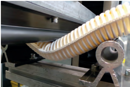
标准弯曲测试验证了e-skin® soft的柔韧性, 即使在足以破坏其他拖链的负载作用下, 它也只是发生正常弯曲。
